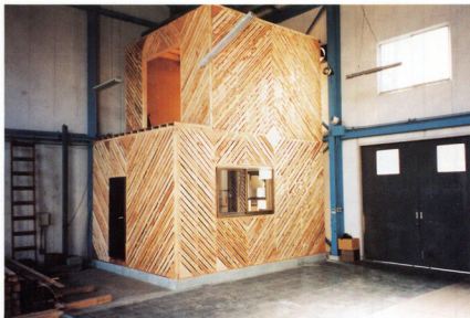
写真左：東京工芸大学工学部の構造実験室にあるTIP構法のモデル棟。
